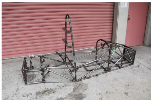
金属パイプを溶接して接合、組み上げて作るのが「パイプフレーム」
