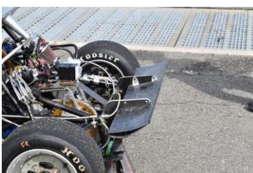
メインのリアウィングに加え、低い位置にもウィングを搭載する
