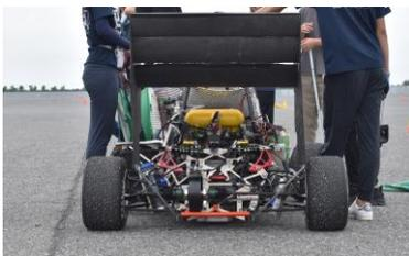
アルミ削り出しバルクヘッド、黄色の吸気サージタンクと、変更がないのがわかる
